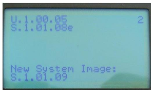
Abbildung 8: System-Firmware wird auf den UC3A-Chip geladen
