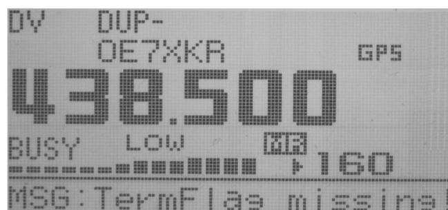
Figure 32: Feedback HF: RX Message „Termination flag missing“
