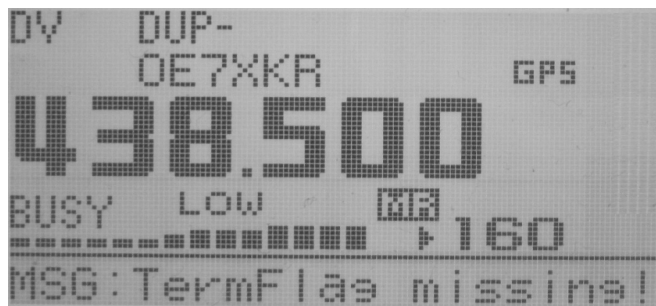
Abbildung 30: Quittierung HF-Empfang: RX Message „Termination flag missing“
