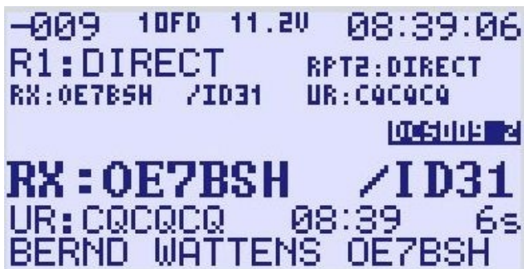
Abbildung 26: Hotspot-Betrieb, Symbolrate HF-Empfang
