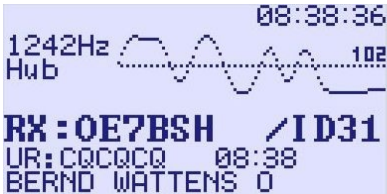
Abbildung 25: Hotspot-Betrieb, Hubanzeige HF-Empfang
