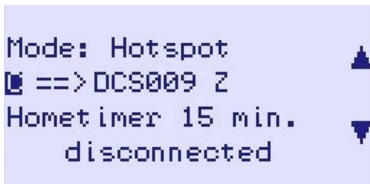
Abbildung 23: Hotspot-Betrieb, Auswahl Modul C
