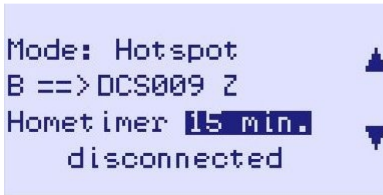
Abbildung 28: Hotspot-Betrieb, Einstellung Hometimer aktiviert mit 15 Minuten
